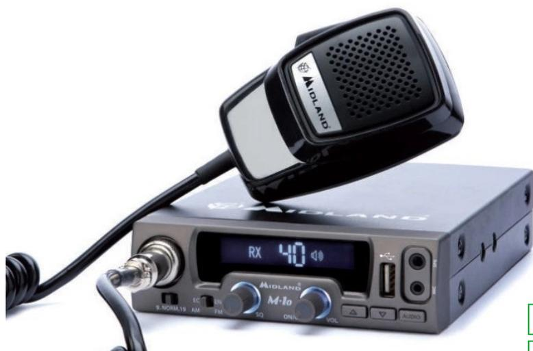
Midland Alan M-10: CB completo, digitale e multibanda. Monta una porta USB che permette di attingere all'energia per caricare cellulari, tablet ed altri device.
